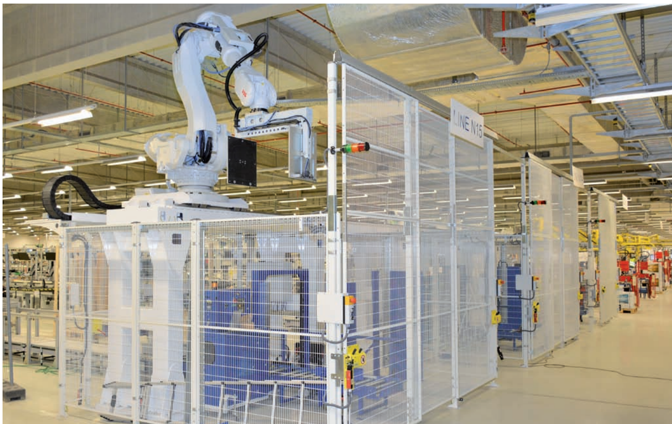
Priemyselný robot ABB IRB 6650S sa presúva medzi tromi linkami vo výške 2,4 m nad zemou.
